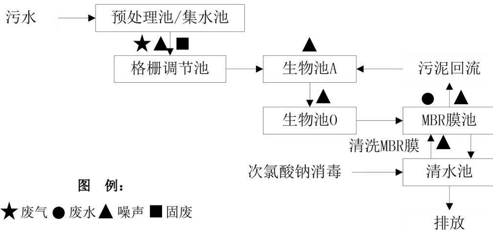
图 1 污水处理工艺及产污环节图
