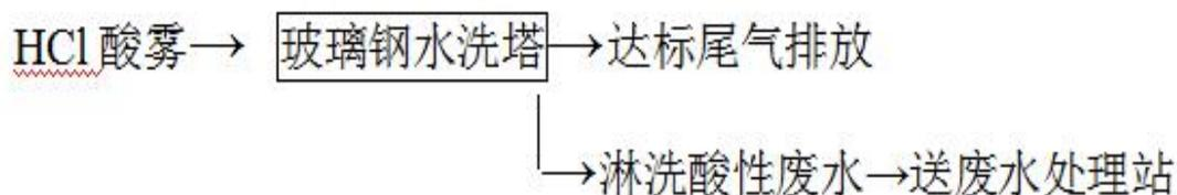
图 5. 喷淋塔工艺流程图
