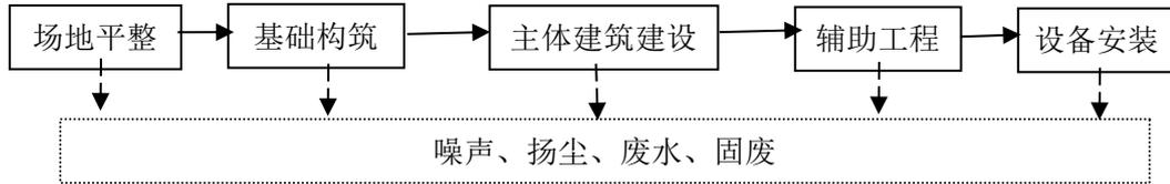
图2 项目施工期工艺流程及产污环节图
