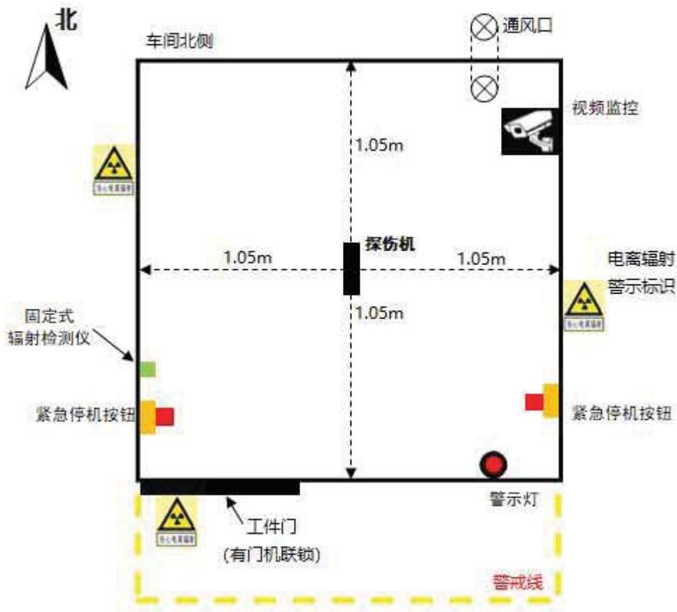
图5 本项目整体铅房辐射防护设施安装位置示意图
