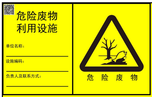
图 7 危险废物暂存间标识牌
